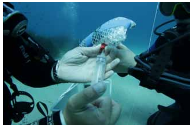
Wasserproben zur Gasanalyse werden unter Wasser in ein Reaktionsgefäß umgefüllt.
